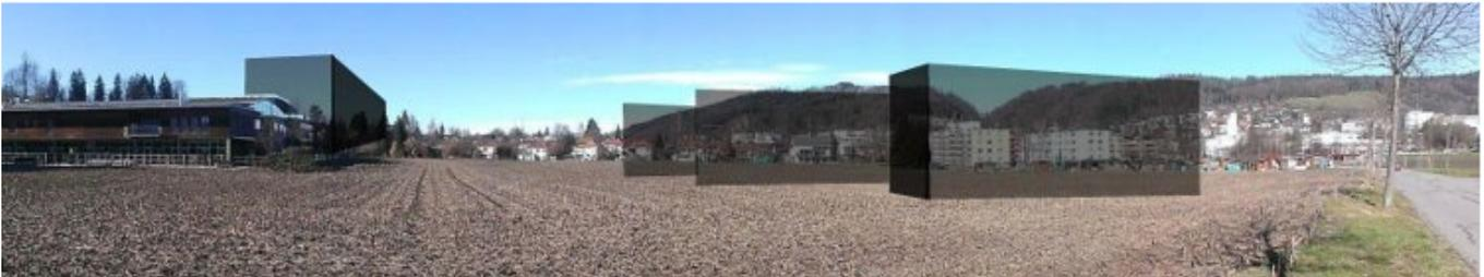
Fotomontage, Bauvolumen, ca.25'000m<sup>2</sup> \*) BGF, z.B. 3 Blöcke, 5-geschossig, je LXBXH 73X14X15m und Gewerbeblock
